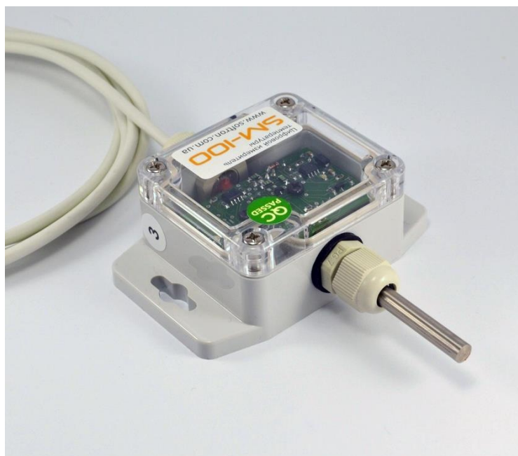
Рис. 1. Внешний вид модуля измерения температуры воздуха SM-100 Влагозащищенный корпус IP67. Герметичный датчик в гильзе из нерж. стали диаметром 6 мм и длиной 50 мм.
