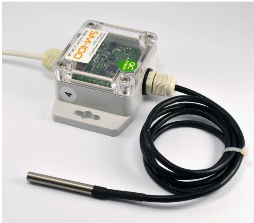
Рис. 2. Внешний вид модуля измерения температуры воздуха / почвы / жидкости SM-100.W Влагозащищенный корпус IP67. Герметичный датчик в гильзе из нерж. стали диаметром 6 мм и длиной 50 мм. Длина кабеля датчика – до 20 м.
